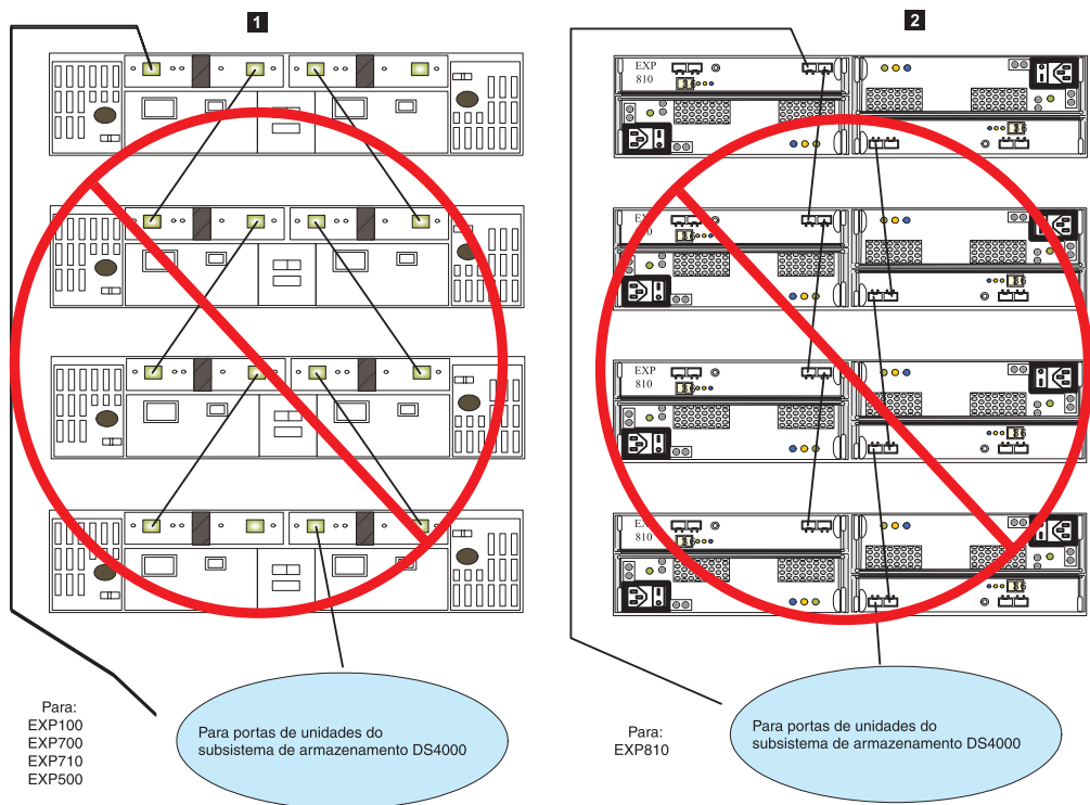
Figura 38. Esquema de loop de cabo não suportado para conexão de dispositivos de armazenamento (1 de 2)
